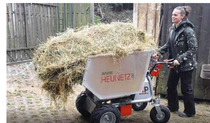
**Leichtgutowanne 450 L Anbaugerät für Multi Dumper**
